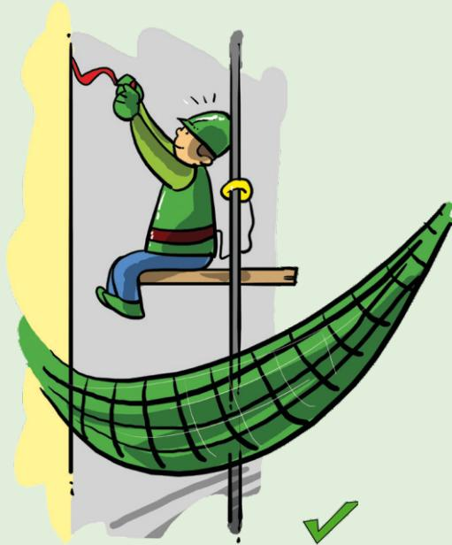
U svim radnim zonama gdje postoji rizik od pada, mora postojati zaštita na 360°. To se postiže kroz dvostrukе zaštitne rampe, prečage za sprečavanje klizanja i obezbjeđivanje minimalnog razmaka između radnih platformi i bilo kakvog objekta. Sigurnosne mreže i opasači takođe mogu pojačati pojačati bezbjednost. Međutim, oni ne mogu spriječiti pad već samo ublažiti posljedice pada.
