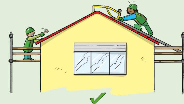
Kontrolne mjere koje će spriječiti da radnici padnu mogu uključivati gornju zaštitnu rampu na visini od oko 1 metar i srednju zaštitnu rampu na visini od oko pola metra iznad radne platforme. Potrebna je i poprečna greda za gaženje, koja će spriječiti da predmeti padnu na ljude koji rade ispod.
